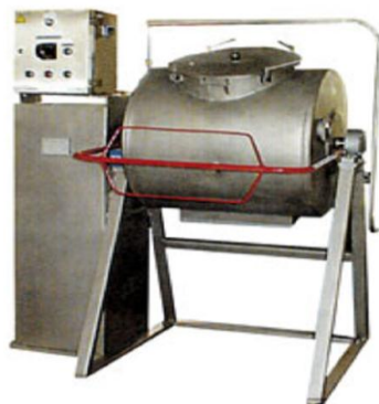
Рисунок 3.1 – Металлический безвальцовый маслоизготовитель
