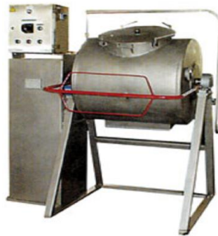
Рисунок 3.1 – Металлический безвальцовый маслоизготовитель
