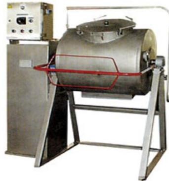
Рисунок 3.1 – Металлический безвальцовый маслоизготовитель
