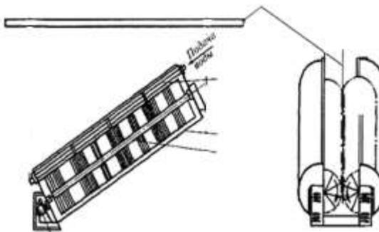
1 – барабан; 2 – трубы; 3 – щетки; 4 – редуктор.
