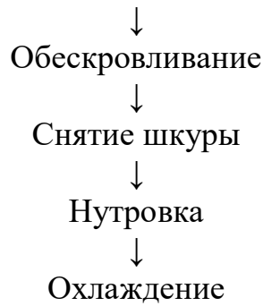
Рисунок 1.1 – Технологическая схема первичной переработки убойных животных
